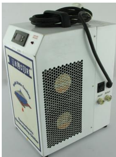
1.29-сурет – Термoeлектрлік салқындатқыш (Melcor компаниясы, АҚШ)
