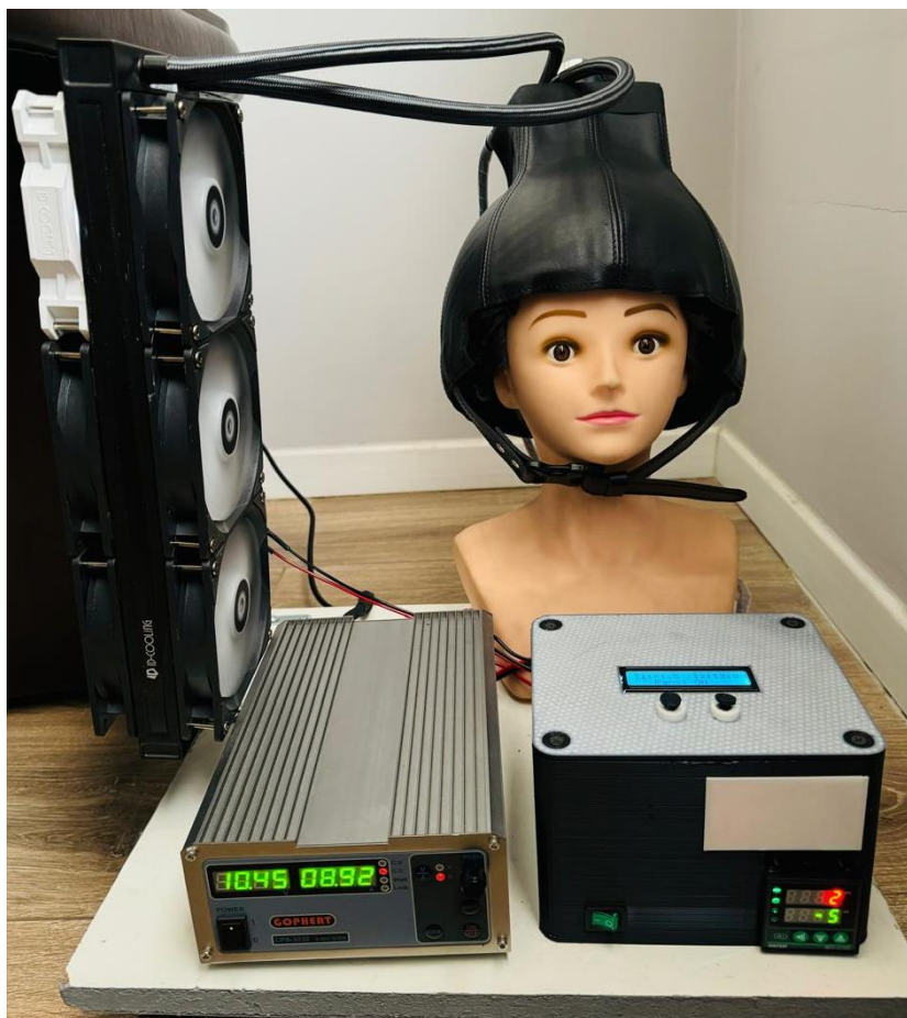
3.2-сурет – Термоэлектрлік құрылғының прототипін эксперименттік зерттеу нәтижесі
